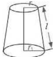
Усеченный конус – часть конуса, заключенная между основанием и секущей плоскостью, параллельной основанию.
